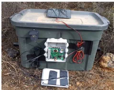
Figura 3 Registrador de datos alimentado por energía solar para registrar la humedad relativa, el punto de rocío, la temperatura, la localización GPS y los datos de actividad individual de los roedores.
